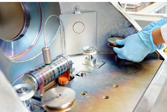
Garnbeschichtungsanlage für leitfähige Garne
